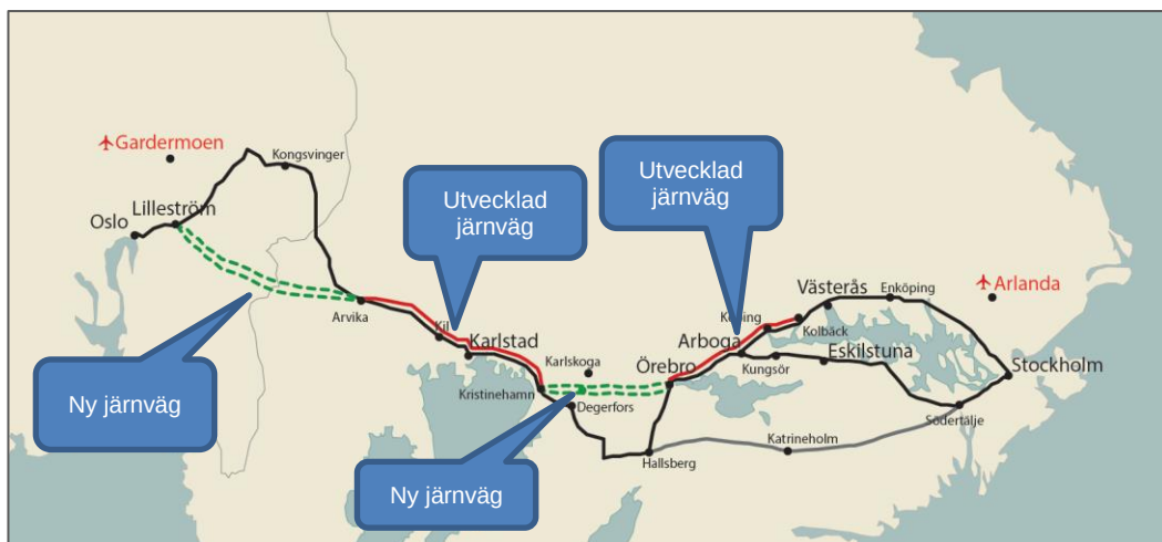
Figur 20. Utredningsförslaget som Swecos nyttoanalys baseras på. Förslaget innebär dubbelspår på hela sträckan eftersom det redan finns dubbelspår på delavsnitten Oslo-Lilleström och Kolbäck-Stockholm. Karta: Sweco
