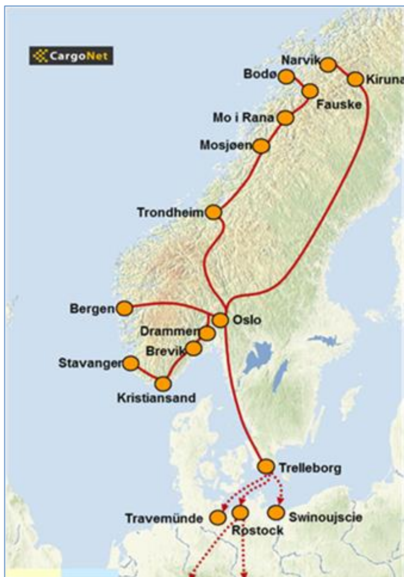
Figur 48. Kombitransportsystem på järnväg som bland annat går via Värmlandsbanan till och från Nordnorge 195 mil avverkas på 26,5 timmar. Källa: CargoNet
