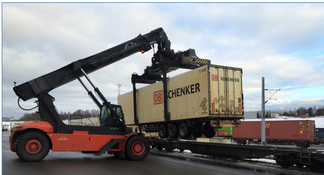
Bild 4. Intermodal hantering av trailer, container och växelflak på godsterminaler har utvecklats både i Sverige och Norge. Kraven ökar och 750 meters tåglängder med möjlighet för direktkörning ut på det allmänna järnvägsnätet är numera ett viktigt effektivitetskrav Källa: DB Schenker
